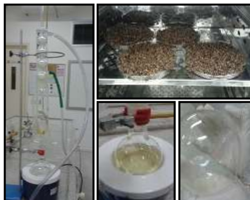
Figura 1. Secagem das sementes, extração do óleo pelo Soxhlet e óleo após extração.
